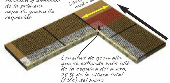
Longitud de geomalla que se extiende más allá de la esquina del muro, 25% de la altura total ( $H/4$ ) del muro
