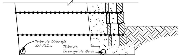
Los tubos de drenaje deben desaguar hacia el exterior o conectarse a una red de alcantarillado de aguas pluviales.
