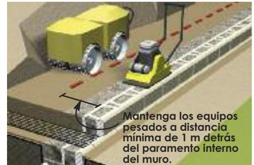
Mantenga los equipos pesados a distancia mínima de 1 m detrás del paramento interno del muro.
