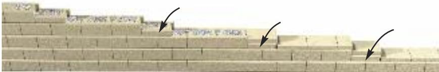
Para un escalonamiento completo de la hilada, utilizar un bloque de esquina AB.
