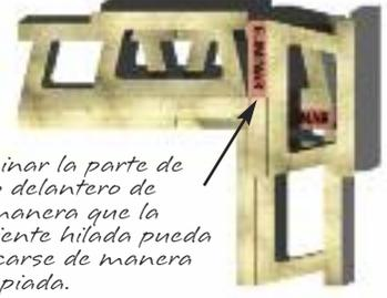
*Eliminar la parte de labio delantero de tal manera que la siguiente hilada pueda colocarse de manera apropiada.*
